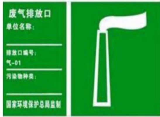
图 8.2-1 规范化废气及废水排放口标志牌
